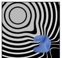
Magnetfeldänderung Biopor AB Xtrack im Metall-detektor
